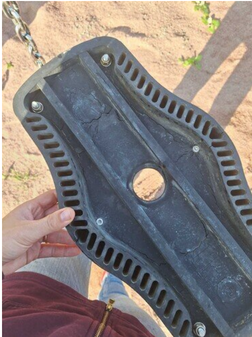
Kuva 29 Keinun istuin kuiva/halkeilee
